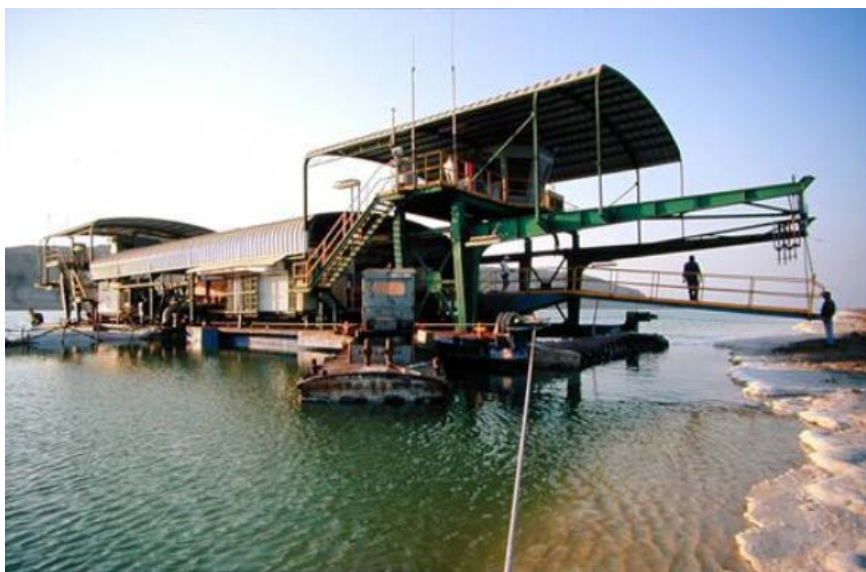
用挖泥船从池塘河床上获取光卤石。由以色列化工集团 (ICL) 拍摄。
